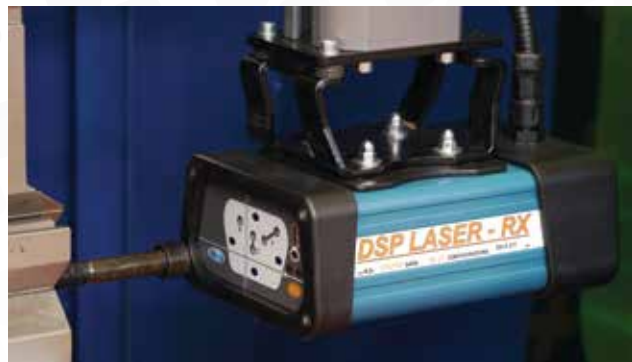
Impianto laser di sicurezza
