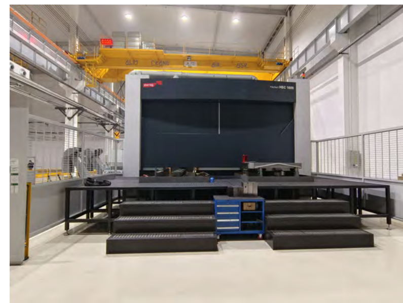
Heckert HEC1600 Centro di lavoro a cambio pallet di alta precisione Precisione di posizionamento 4um/2.5um
