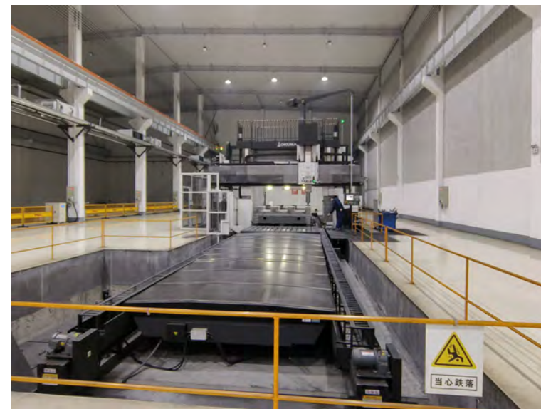
Okuma Giappone Centro di lavoro Gantry a cinque assi Precisione di posizionamento 4um/1.5um
