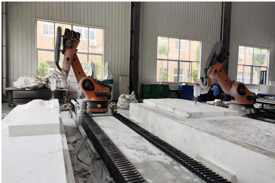
Produzione di modelli con Robot Granigliatrice
