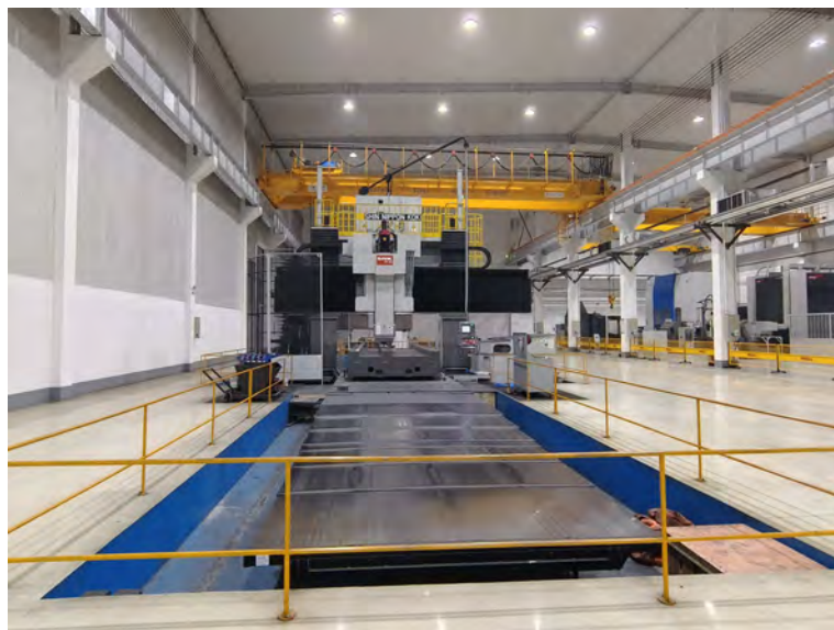
SNK NEOV-5M-E Giappone Centro di lavoro Gantry a cinque assi Precisione di posizionamento 4.5um/1.5um
