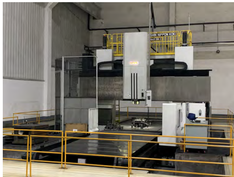
Giappone SNK HF-6M Giappone Centro di lavoro Gantry a cinque assi Precisione di posizionamento RP 4.5um/1.5um
