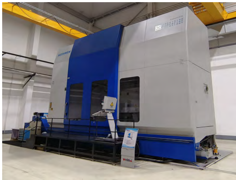
KEHREN Gmbh Ri 14-4 Rettificatrice verticale di alta precisione Precisione di posizionamento 0.003mm/0.002mm
