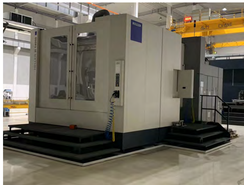
HELLER H14000 Centro di lavoro orizzontale Precisione di posizionamento 3.5um/1.5um
